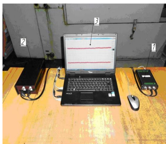
Рис. 2. Контрольно-измерительная аппаратура-анализатор спектра модели ZET A17-U2
