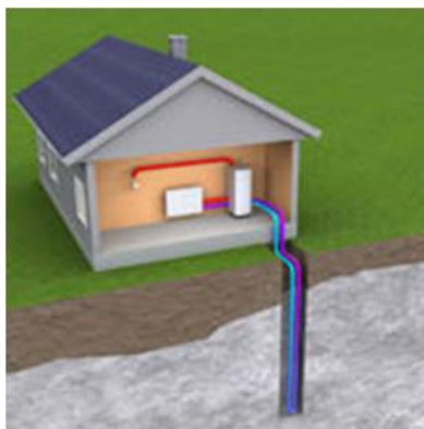
Рис. 1 – Грунтовый вертикальный тепловой насос скважинного типа
