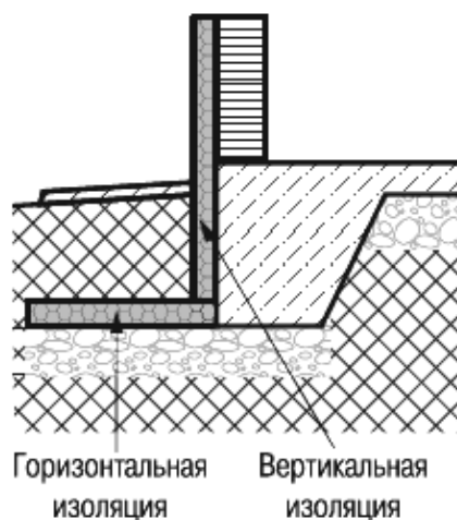
Рис. 1. Конструкция морозозащещенного фундамента мелкого заложения
