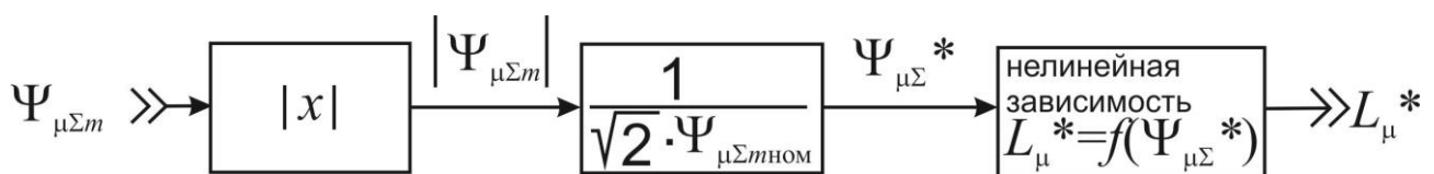
Рис. 2. Структурная схема для получения мгновенного значения L_{\mu}^* - полной индуктивности фазы обмотки статора от основного магнитного потока в относительных единицах
