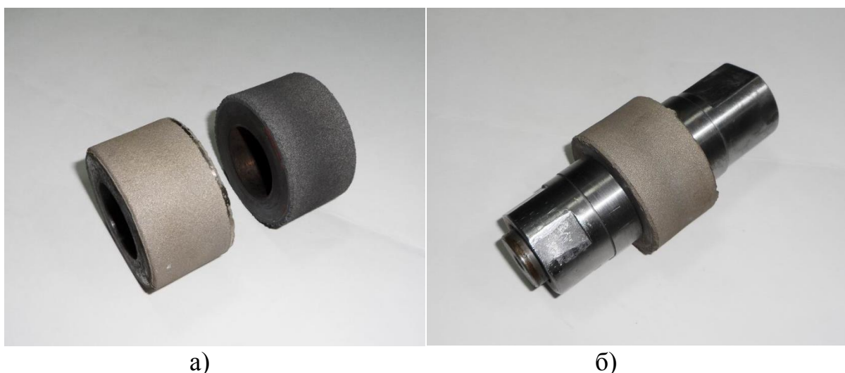
Рис. 4. Образцы для исследований: а – плазменно-напыленные образцы; б – образец на оправке
