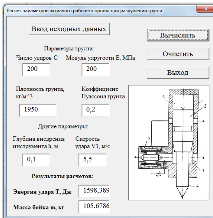
Рис. 2. Рабочее окно определения параметров активного рабочего органа (мерзлый грунт, C=200 )
