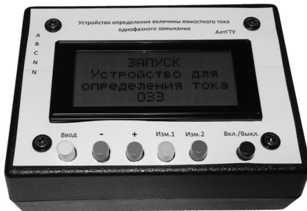
Рис. 1. Устройство для определения тока ОЗЗ
