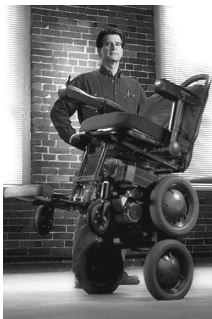
Рис. 1. Диан Кеймен с медицинским аппаратом Independence 3000 IBOT Transporter (США) в гиростабилизированной конфигурации на двух точках опоры (основная опция)
