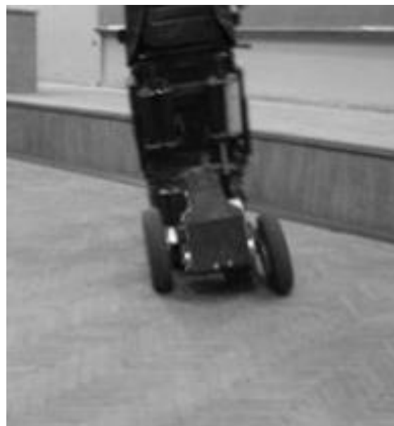
Рис. 6. Испытания в 2004 г. (СПбПУ) российского ходового макета транскутера семейства «Кенгуру» с двухплоскостной гиростабилизацией (опция «поперечная трансформация»)
